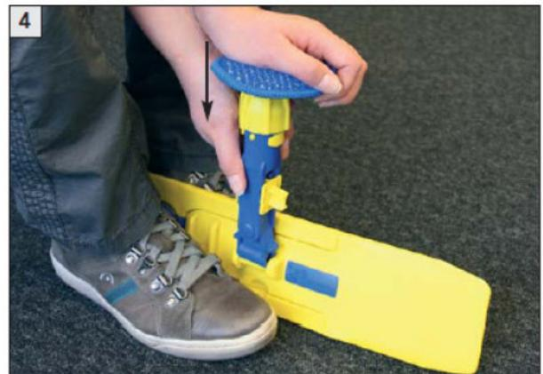
4. Um das neue Gelenk an der Bodenplatte zu befestigen, klemmen Sie die Platte senkrecht zwischen Ihre Füße. Stellen Sie das neue Gelenk mit Hilfe des gelben Schiebers fest und setzen Sie es mit der entsprechenden Öffnung von oben auf den abgeflachten Bolzen. Anschließend drücken Sie mit ausreichend Kraft und einem Pad als Schutz für Ihre Hand das Gelenk fest nach unten.
