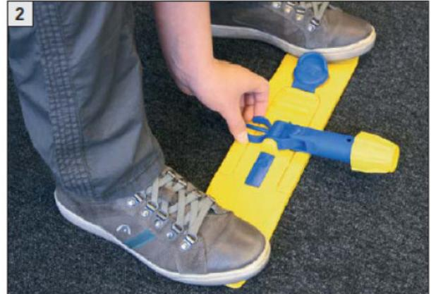
2. Setzen Sie sich anschließend auf einen Stuhl und legen Sie die Bodenplatte vor sich auf den Boden. Stellen Sie sich mit beiden Füßen auf die Platte, so dass diese nicht verrutschen kann. Kippen Sie das (alte) Wischergelenk senkrecht nach vorne und stecken Sie den Clip zwischen Gelenk und Bodenplatte.
